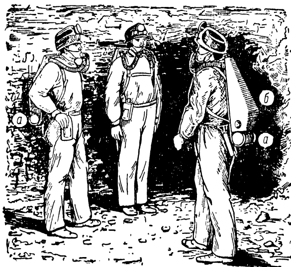
Рис. 30. Спасательный отряд в коях, снабжённый стальными цилиндрами с кислородом.
